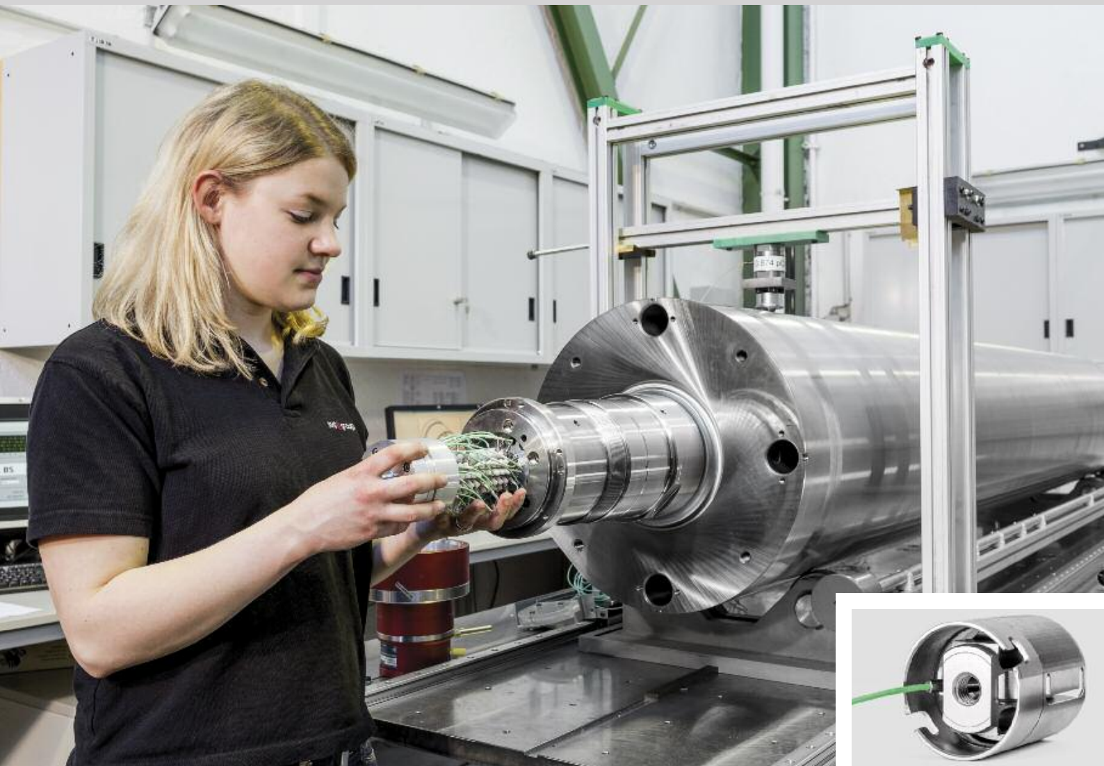
Präzises X-Shape-Planheitsmesssystem mit Messrollen der neuesten Generation.
