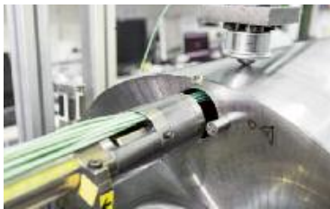
Messsensor mit Konushülse (l); Einbau des Messsensors (m); Signalübertrager (r).
