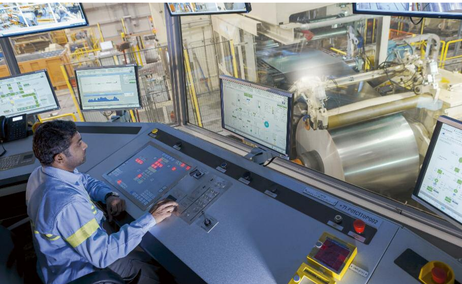
Steuerstand einer Aluminiumkaltwalzanlage.
